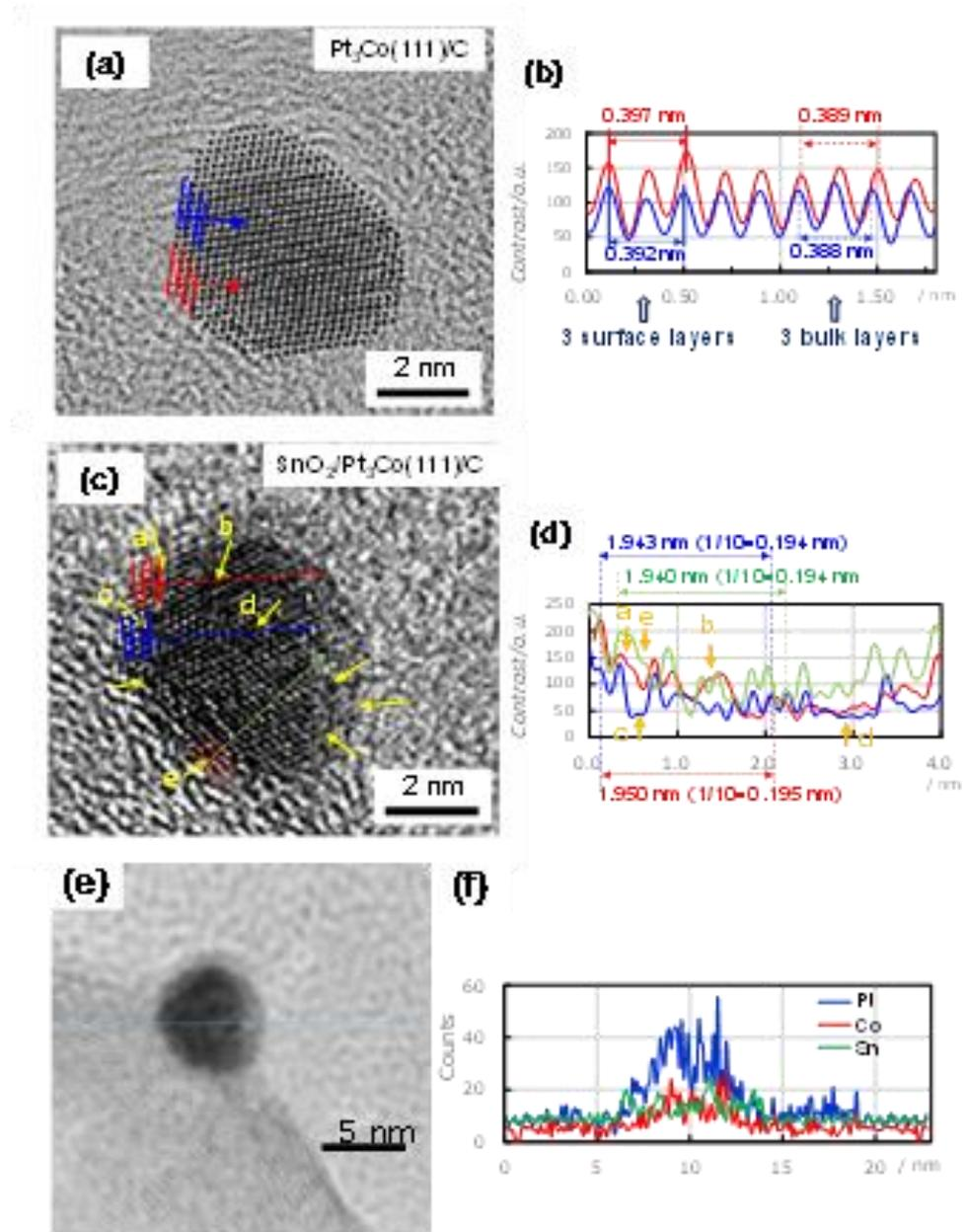
成果2. 走査型透過電子顕微鏡 (STEM) 像(a, c, e)–EDS プロファイル(b, d, f)。
