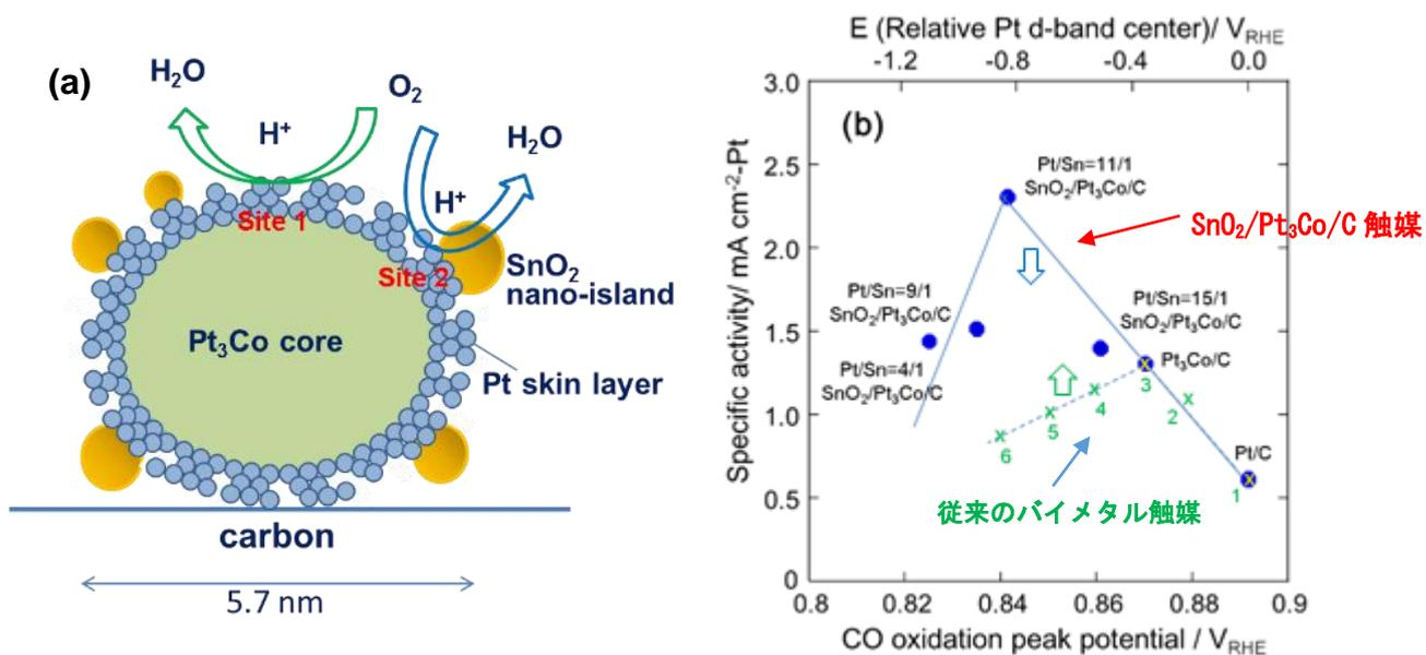
成果1. 新型 SnO<sub>2</sub> ナノ粒子/Pt<sub>3</sub>Co/C 電極触媒の活性構造 (二つの反応サイト) (a) と Sn/Pt 比による触媒性能のチューニング (b)。
