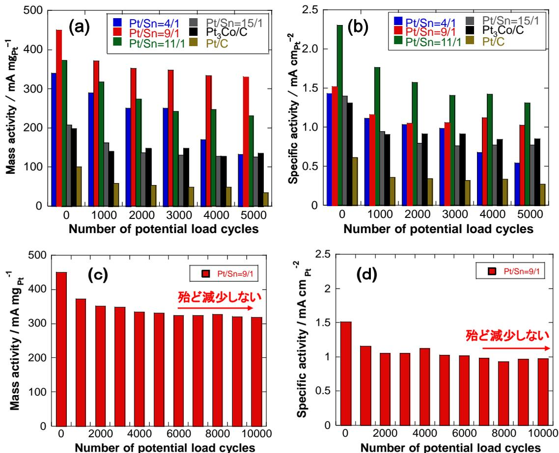
成果3. SnO<sub>2</sub>/Pt<sub>3</sub>Co/C 電極触媒は、通常の Pt/C 電極触媒に比べ約 5-8 倍の高い活性を示し、Pt<sub>3</sub>Co/C 電極触媒に比べても 2 倍以上の質量活性を示す (a, b)。さらに、SnO<sub>2</sub>/Pt<sub>3</sub>Co/C は 1 万回の電圧負荷試験を行っても殆ど減少しない優れた耐久性を示す (c, d)。
