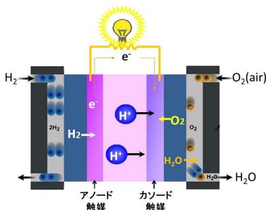
図1. 固体高分子形燃料電池の原理
